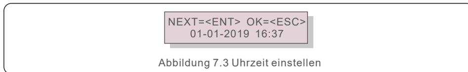
Drücken Sie die Tasten AUF/AB, um Zeit und Datum einzustellen. Drücken Sie die Taste ENTER, um von einer Ziffer zur nächsten zu wechseln (von links nach rechts). Drücken Sie die Taste ESC, um die Einstellungen zu speichern und zum vorherigen Menü zurückzukehren.
