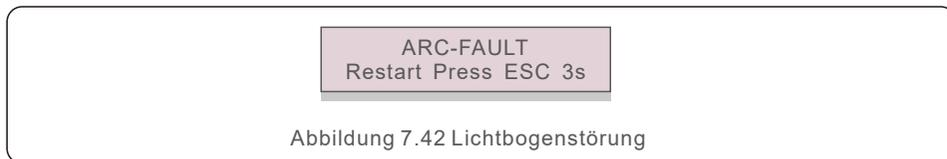
Der Installateur muss den DC-Stromkreis gründlich überprüfen, um sicherzustellen, dass alle Kabel korrekt befestigt sind.
