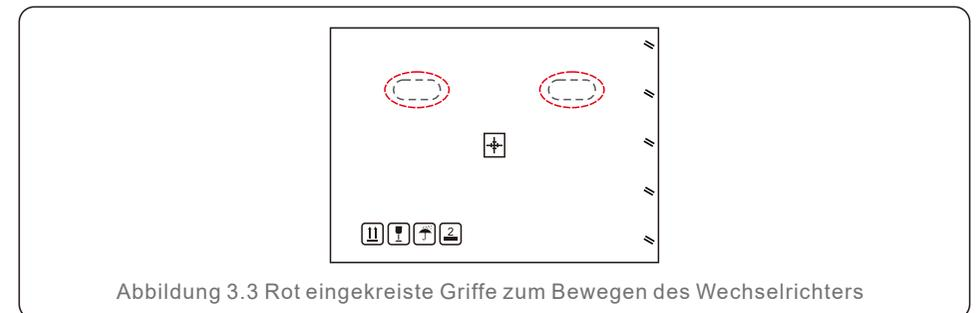
2. Zum Herausnehmen des Wechselrichters aus dem Versandkarton sind zwei Personen erforderlich. Verwenden Sie die in den Kühlkörper integrierten Griffe, um den Wechselrichter aus dem Karton zu nehmen (siehe Abbildung 3.4).
