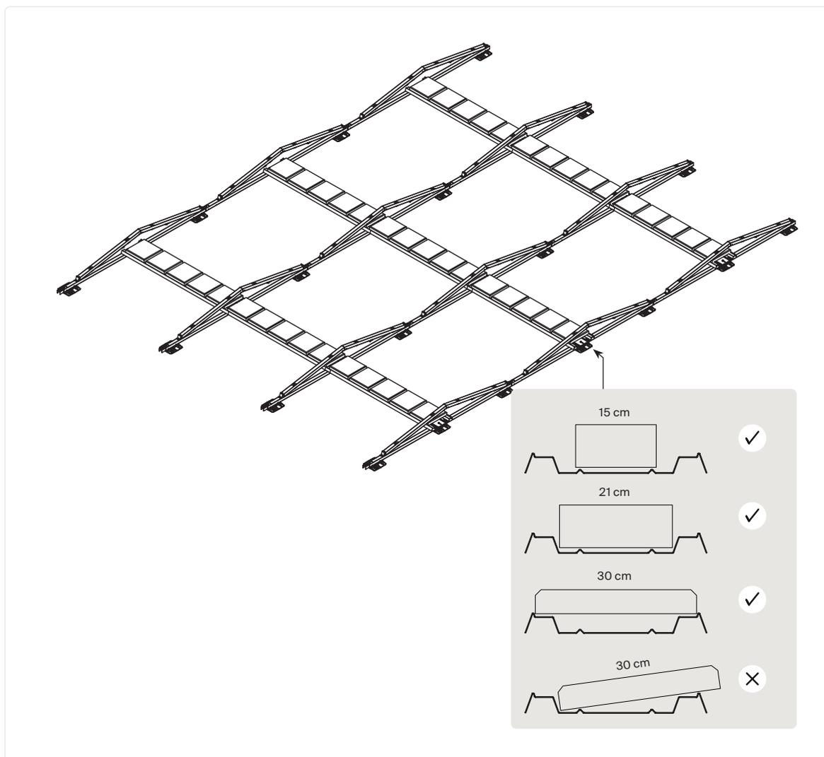
1. Setzen Sie das Solarmodul ① auf den Träger ③. Beachten Sie, dass das Solarmodul von der Kante gestützt werden sollte an das Ende des Trägers.
