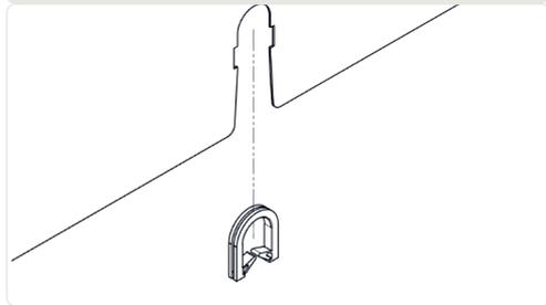
3. Falten Sie die Oberkante der Seitenplatte um. Sie können die Seitenplatte sowohl für die linke als auch für die rechte Seite des Montagesystems verwenden.
