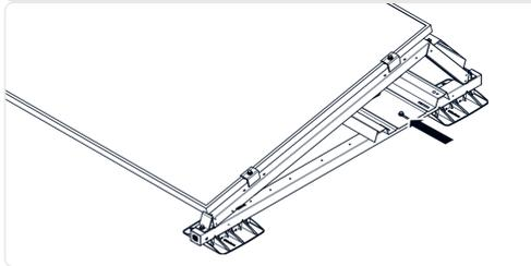
2. Klicken Sie den Kabelschutz in die Seitenplatte.
