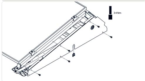
5. Beim symmetrischen Autarco-Matrix-Montagesystem: Wiederholen Sie die Schritte 2 bis 4 für die übrigen Ballastträger.
