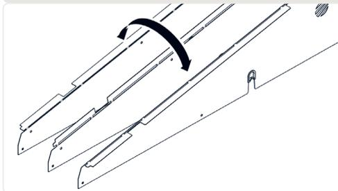
4. Bringen Sie die Seitenplatte an das System an. Falls notwendig, drücken Sie die Kabel in den Kabelschutz. Schrauben Sie die Seitenplatte mit den fünf Schrauben fest.
