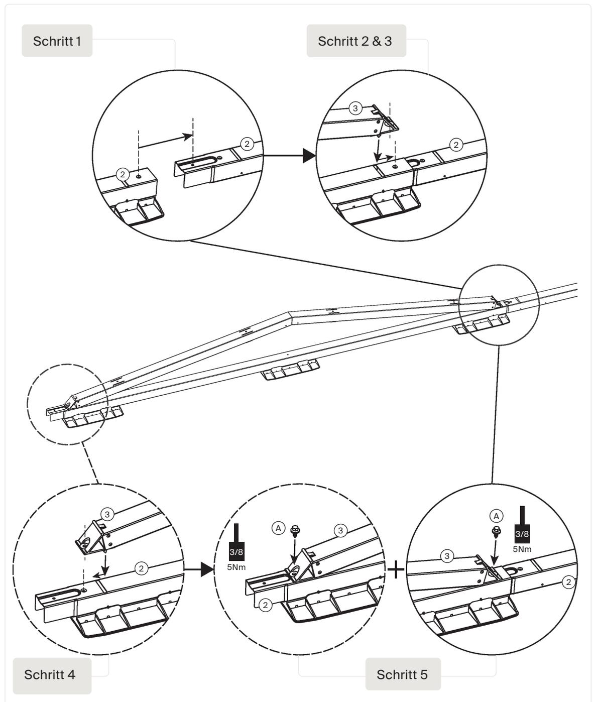
1. Verwenden Sie das Größenanpassungswerkzeug ③ um die Basiseinheiten zu positionieren ② um sie im richtigen Abstand zueinander zu positionieren. Stellen Sie sicher, dass das System gerade und rechtwinklig ist, indem Sie eine der folgenden Methoden anwenden:
