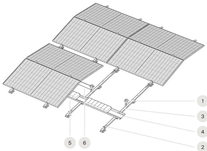
Coloca el panel en el sistema de montaje y accede fácilmente a las abrazaderas.
