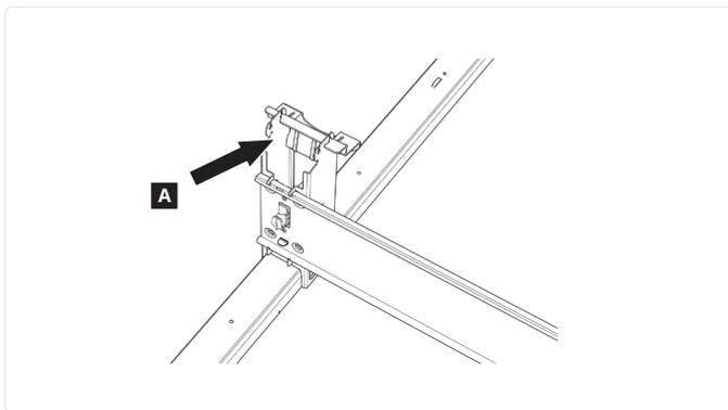
6. Schrauben Sie alle in den Schritten 3 und 4 angebrachten Ballasträger und Ballastverbinder ab und entfernen Sie sie.
