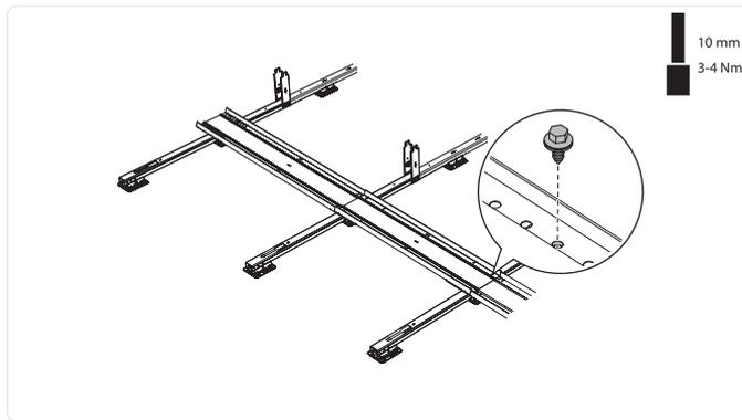
5. Befestigen Sie den Ballastträger mit vier kurzen Schrauben.
