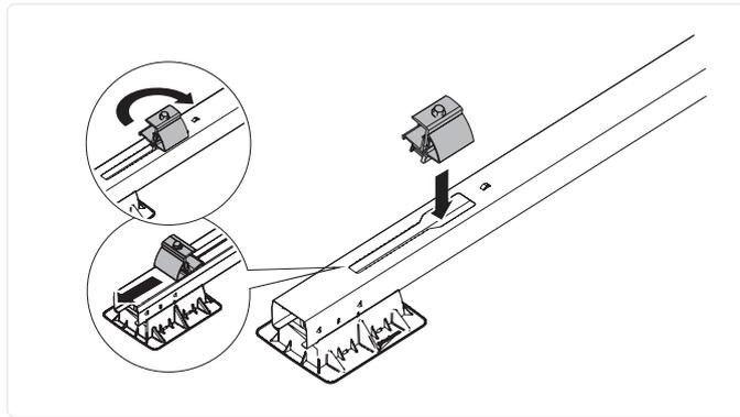
13. Drehen Sie die unteren Klammern in die Basiseinheiten und schieben Sie sie nach hinten in den Kanal.
