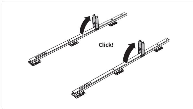
1. Platzieren Sie die erste Reihe der Basiseinheiten entsprechend dem Konfigurationsplan auf dem Dach.
