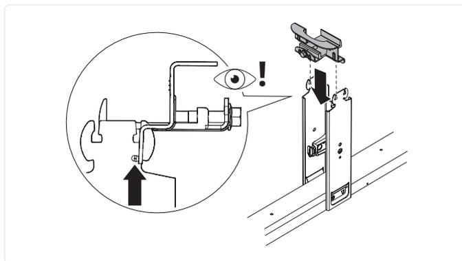
14. Setzen Sie die oberen Klemmen nach oben gerichtet in eine Seite der Stützen ein.
