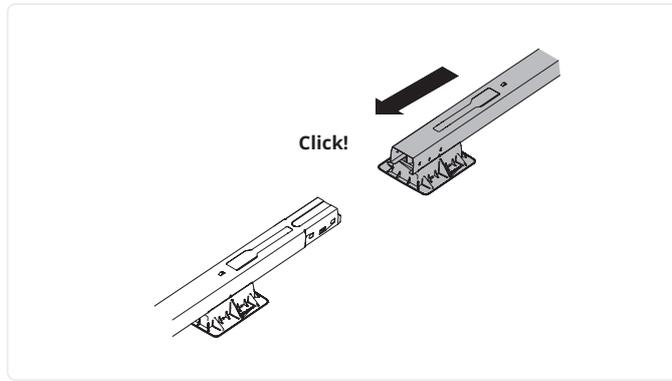
8. Platzieren Sie die nächste(n) Reihe(n) Basisplatte(n) gemäß dem Aufbauplan auf dem Dach. Schieben Sie die Basiseinheiten ineinander, bis Sie ein Klicken hören.
