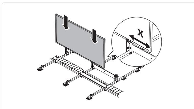
15. Legen Sie das Modul aufrecht in die oberen Klammern. Richten Sie das Modul so aus, dass der Abstand zwischen der kurzen Seite des Moduls und der Klemme (x) auf beiden Seiten gleich groß ist.
