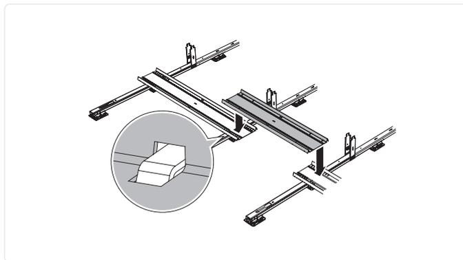
4. Platzieren Sie den Ballastverbinder zwischen den Ballastträgern
