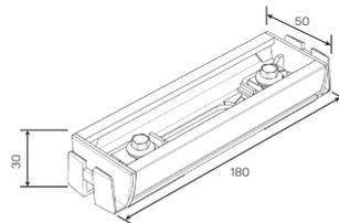
Soporte para montaje vertical (mm)
